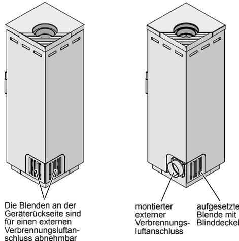
Die Blenden an der Geräterückseite sind für einen externen Verbrennungsluftanschluss abnehmbar
