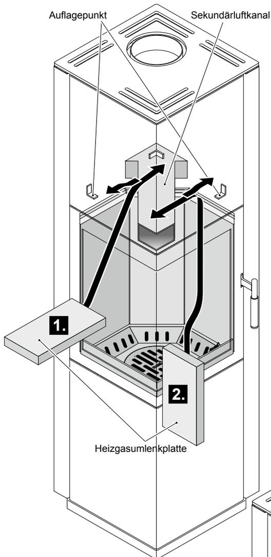
Legen Sie die oberen beiden Heizgasumlenkplatten auf den Sekundärluftkanal.
