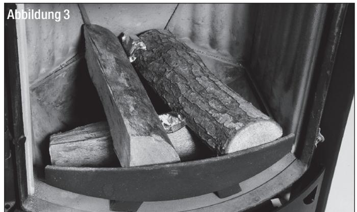
Auf die Holzscheite schichten Sie eine großzügige Menge klein gespaltenes Anzündholz. Achten Sie darauf, dass sowohl die Holzscheite, als auch das Anzündholz aufgelockert liegen, damit genügend Verbrennungsluft an das Brennholz gelangt (Abb. 4).
