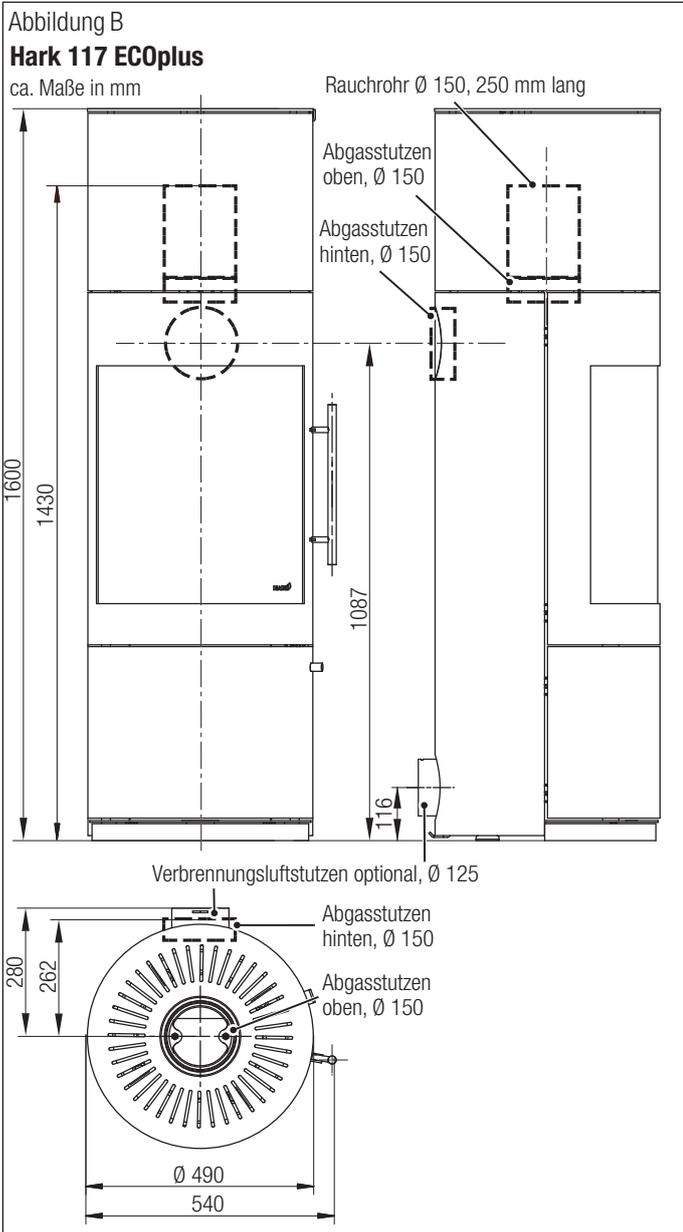
**!** Zu temperaturempfindlichen oder brennbaren Materialien ist vom Rauchrohr ein Mindestabstand von 45 cm einzuhalten. Führt das Rauchrohr durch Bauteile aus brennbaren Baustoffen, so sind die Bauteile in einem Umkreis von mind. 20 cm durch Brandschutzdämmung (z. B. Promasil 950 KS) zu ersetzen. Zusätzlich muss die brennbare Wand mit einer 2 cm starken Vorsatzplatte aus Kalziumsilikat versehen werden, die den Strahlungsbereich des Rauchrohres (45 cm) absichert.
