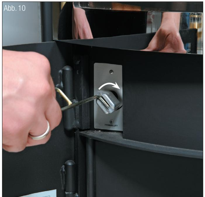
Sind auch diese Holzscheite rundherum angebrannt, sollten Ofen und Abgassystem weitgehend die Betriebstemperatur erreicht haben. Jetzt können Sie die Primärluft-Einstelleinrichtung (links) im Uhrzeigersinn auf "MIN" stellen (Abb. 10) und die Verbrennung hauptsächlich über die Sekundärluft-Einstelleinrichtung (rechts) regeln. Die Anheizeinrichtung kann geschlossen werden.
