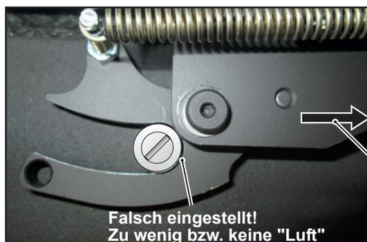
Die Feuerraumtürverriegelung muss weiter nach rechts verschoben montiert werden.
