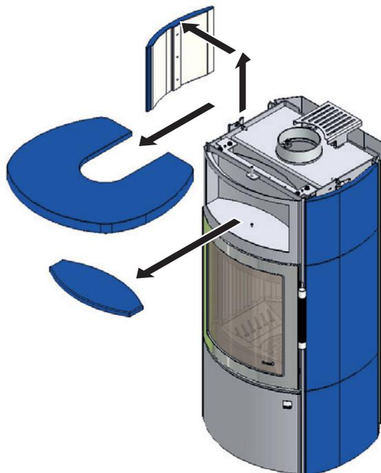
2. Schrauben Sie das Warmhaltefach ab. Hierfür schrauben Sie die oberen vier Muttern von den Senkschrauben. Öffnen Sie die Feuerraumtür und schrauben Sie die Mutter von der unteren Befestigungslasche des Warmhaltefaches. Nehmen Sie das Warmhaltefach nach vorne ab.
