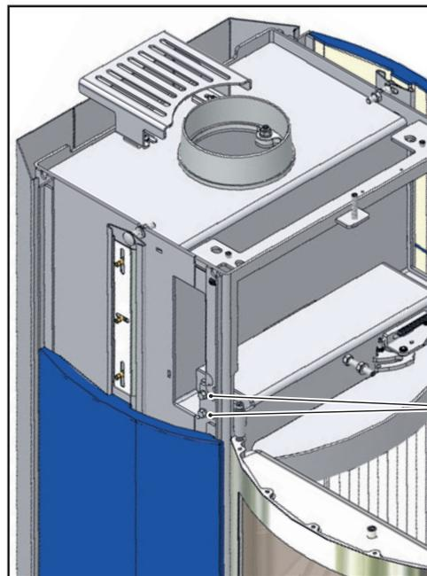
**6.** Heben Sie die Feuerraumtür aus dem unteren Scharnier und nehmen Sie die Feuerraumtür nach oben hin mit dem oberen Scharnier ab.
