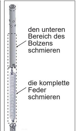
1. Den oberen Scharnierbolzen nach oben herausziehen.
