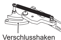
Teile der Feuerraumtürverriegelung (Schloss)
