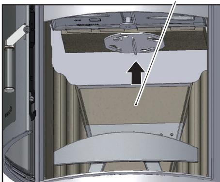
3. Drücken Sie den Befestigungsteller nach oben, drehen Sie ihn und entnehmen Sie ihn zusammen mit der mittleren Heizgasumlenkplatte.
