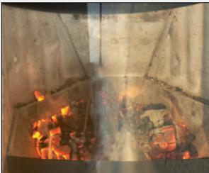
Sekundärluft: Komplett geöffnet ("MAX")
