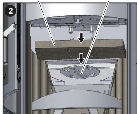
4. Die Bolzen des Tertiärluftkanals greifen in die Bohrungen der oberen Heizgasumlenkplatte. Heben Sie die obere Heizgasumlenkplatte aus den Bolzen, schwenken Sie die Platte seitlich herunter und entnehmen sie.
