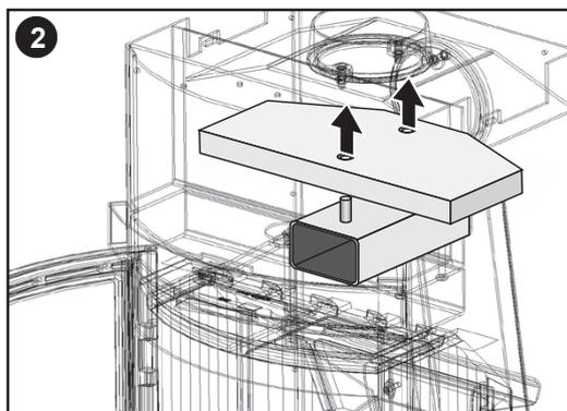
Heben Sie die obere Heizgasumlenkplatte aus den Bolzen.
