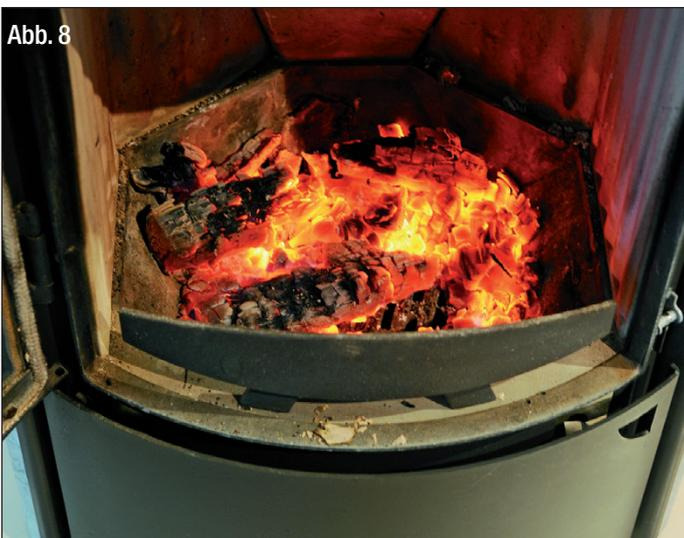
Lassen Sie diese Holzaufgabe mit auf "MAX" stehender Primär- und Sekundärluft herunterbrennen, bis kaum noch Flammen vorhanden sind und das Holz in die Glutphase übergeht
