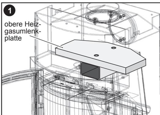
Die Bolzen des Luftkanals greifen in die Bohrungen der oberen Heizgasumlenkplatte.
