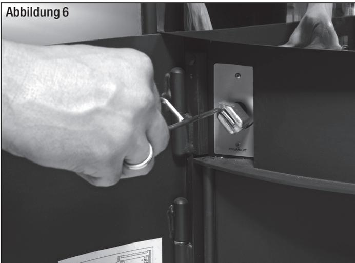
Sind auch diese Holzscheite rundherum angebrannt, sollten Ofen und Abgassystem weitgehend die Betriebstemperatur erreicht haben. Jetzt können Sie den Primärluftregler schließen und die Verbrennung hauptsächlich über den Sekundärluftregler regeln. Für eine optimale Verbrennung sollten Sie den Sekundärluftregler immer mindestens 50 % geöffnet lassen (Abb. 6).
