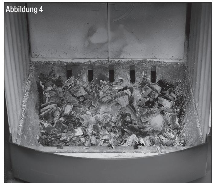
Lassen Sie diese Holzaufgabe mit geöffneten Verbrennungsluftreglern herunterbrennen, bis eine Grundglut vorhanden ist (Abb. 4). Je nach Holzgüte, Schornsteinzug und Witterung dauert diese Verbrennungsphase unterschiedlich lange. Legen Sie jetzt zwei weitere Holzscheite parallel zur Feuerraumscheibe auf und verschließen die Feuerraumtür (Abb. 5).
