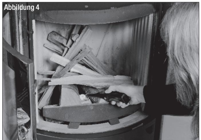
Lassen Sie diese Holzaufgabe mit geöffneten Verbrennungsluftreglern herunterbrennen, bis eine Grundglut vorhanden ist (Abb. 5).
