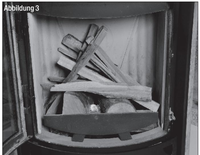
Auf die Holzstücke schichten Sie eine großzügige Menge klein gespaltenes Anzündholz. Achten Sie darauf, dass sowohl die Holzstücke, als auch das Anzündholz aufgelockert liegen, damit genügend Verbrennungsluft an das Brennholz gelangt (Abb. 3).
