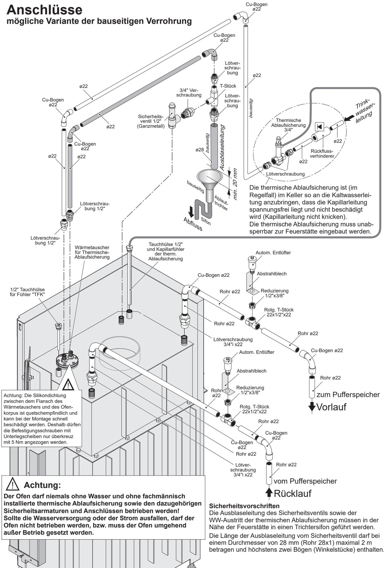
Die thermische Ablaufsicherung ist (im Regelfall) im Keller so an die Kaltwasserleitung anzubringen, dass die Kapillarleitung spannungsfrei liegt und nicht beschädigt wird (Kapillarleitung nicht knicken). Die thermische Ablaufsicherung muss unsperrbar zur Feuerstätte eingebaut werden.
