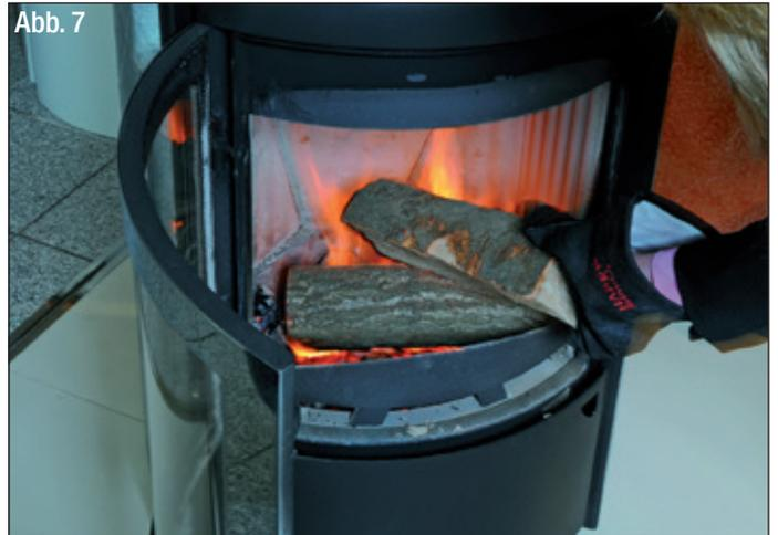
Sind auch diese Holzscheite rundherum angebrannt, sollten Feuerstätte und Abgassystem weitgehend die Betriebstemperatur erreicht haben. Jetzt können Sie die Primärluft-Einstelleinrichtung auf "ZU" stellen (Abb. 8) und die Verbrennung hauptsächlich über die Sekundärluft-Einstelleinrichtung regeln.
