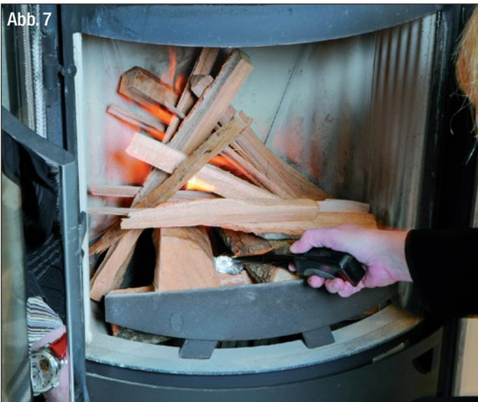
Achten Sie darauf, dass sowohl die Holzscheite als auch das Anzündholz aufgelockert liegen, damit genügend Verbrennungsluft an des Brennholz gelangt.
