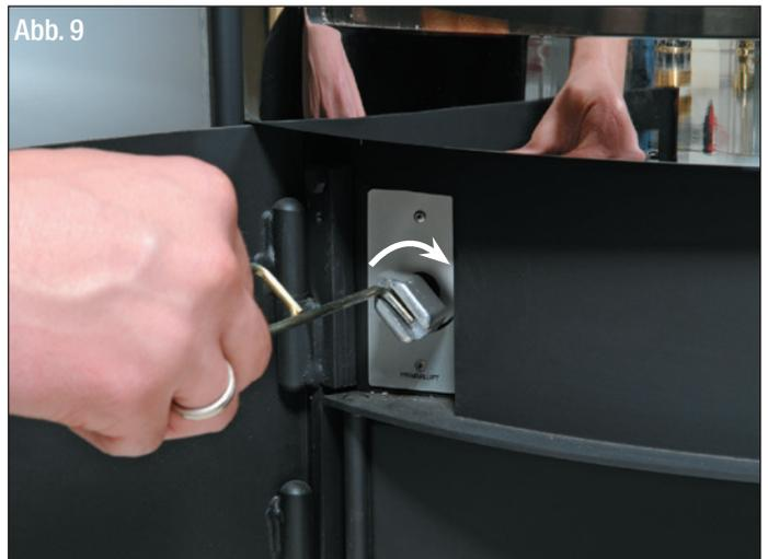
Sind auch diese Holzscheite rundherum angebrannt, sollten Ofen und Abgassystem weitgehend die Betriebstemperatur erreicht haben. Jetzt können Sie die Primärluft-Einstelleinrichtung (links) im Uhrzeigersinn auf "MIN" stellen (Abb. 9) und die Verbrennung hauptsächlich über die Sekundärluft-Einstelleinrichtung (rechts) regeln.
