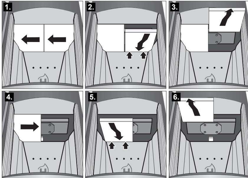
2. Schieben Sie am Griff den Tertiärluftkanal nach oben. Entnehmen Sie die hintere Feuerraumwand.
