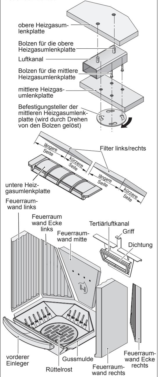
4. Die Bolzen des Tertiärluftkanals greifen in die Bohrungen der oberen Heizgasumlenkplatte. Heben Sie die obere Heizgasumlenkplatte aus den Bolzen, schwenken Sie die Platte seitlich herunter und entnehmen sie.
